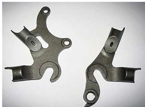
FORCELLINO POSTERIORE DISK ACCIAIO – ANGOLO LIBERO
